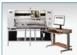
XRFコアスキャナ スウェーデン Cox Analytical Systems社製
