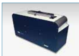
自由落下型画像解析粒度分布計
